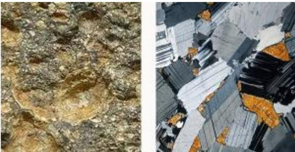
Fig. 5: Immagine macroscopica e microscopica di Anortosite
