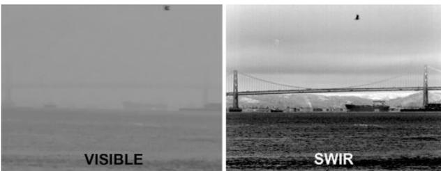
Fig. 13: : Immagini della baia di San Francisco che mostrano la differenza fra la resa nel visibile e con la SWIR camera. L'effetto è simile a quello prodotto dalla funzione "Rimuovi foschia" della Camera Raw di PS.
